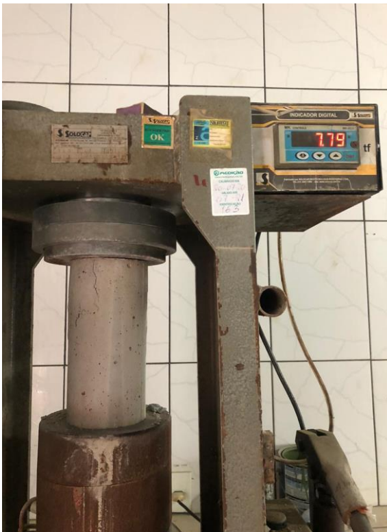
Figura 1: teste de compressão argamassa estabilizada
