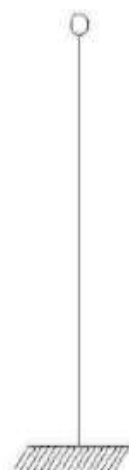
Figura 10 - Vinculação do pilar P1
