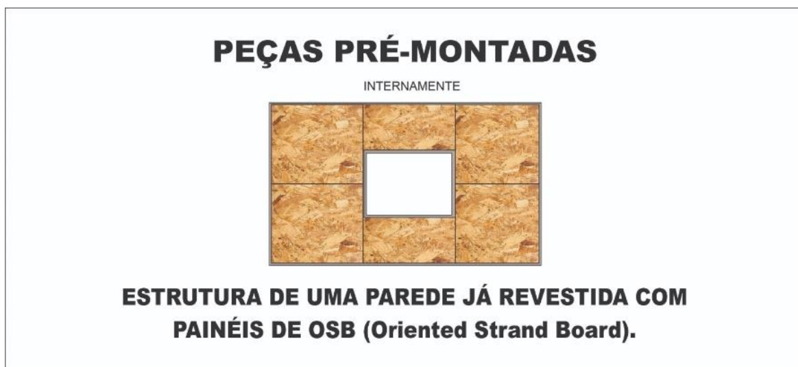
Figura 06: Estrutura de uma parede já revestida com painéis de OSB
